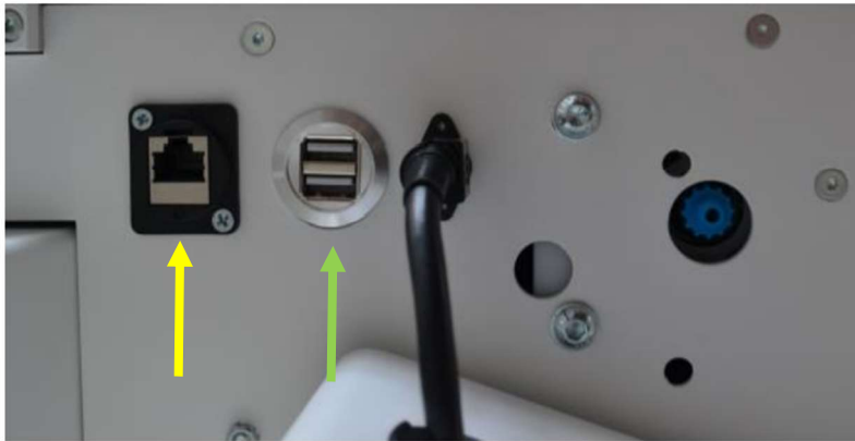
(Gelber Pfeil: LAN-Anschluss, grüner Pfeil: USB-Anschlüsse)
